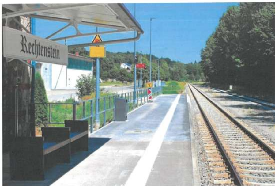
Der nach Osten um 30 Meter auf 120 Meter verlängerte Bahnsteig am Bahnhof Rechtenstein ermöglicht nun auch Halte von Langzügen.
